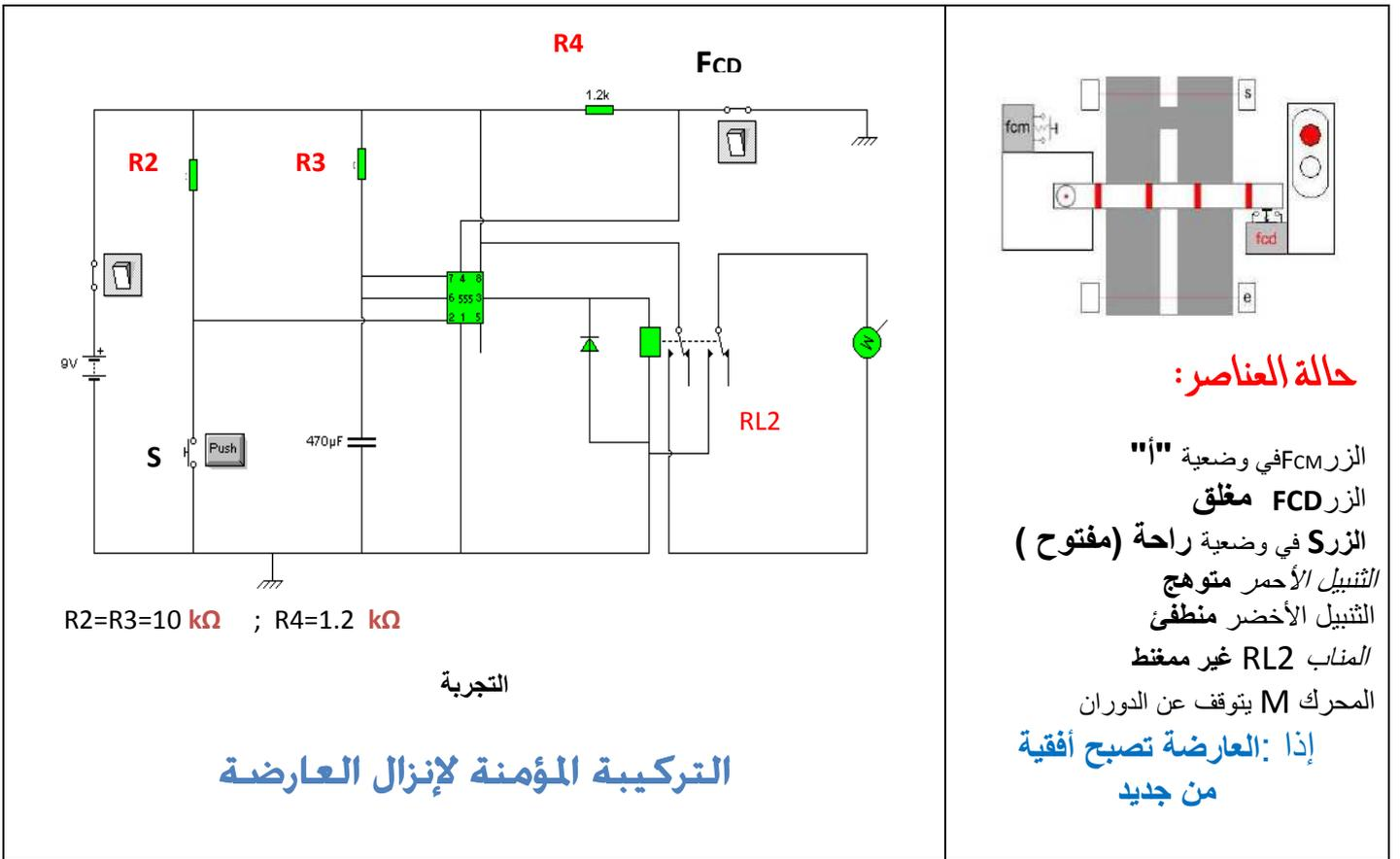
خلاصة: التركيبية الكهربائية المؤمنة لرفع و إنزال العارضة
